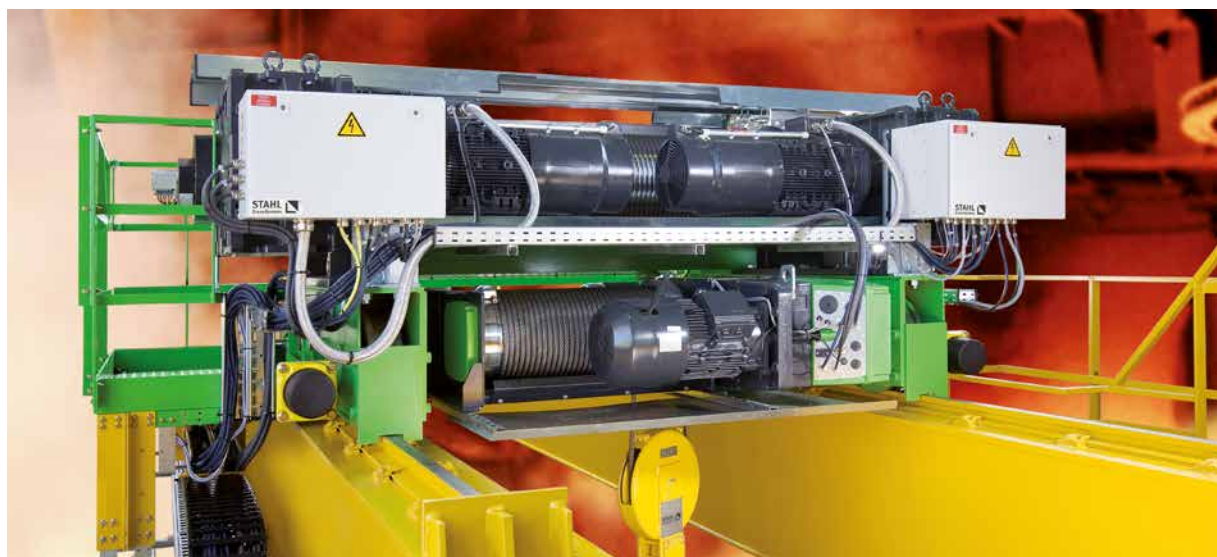
Versión con un polipasto de cable SH como elevación auxiliar
